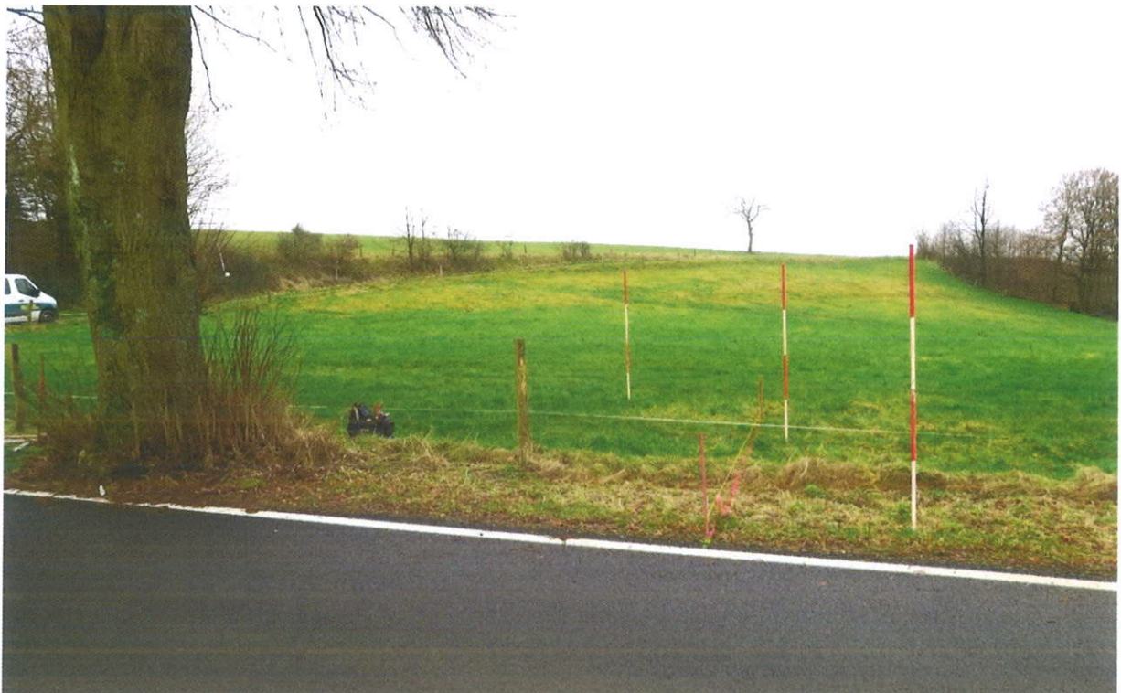
Abb. 9: Bereich Linde Nr. 2, Ansicht von Norden. Absteckung des Wurzelsuchgrabens und der Kronentraufe mittels Fluchtstäben.
