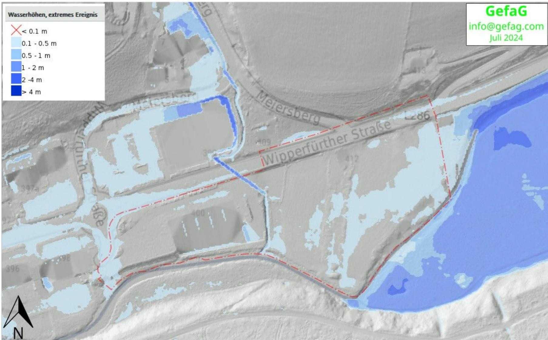
Abbildung 4: Wasserhöhe nach Extremereignis (90mm/h; Simulation)
