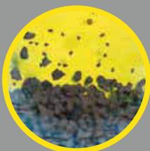
Größere Verunreinigungen setzen sich bereits im Startschacht ab. Der Startschacht dient als Schlammfang.
