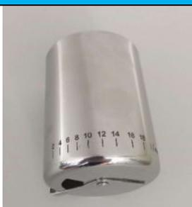
Ein Wasserdurchlaufmengen-Messbecher misst das Volumen des durch ihn hindurchfließenden Wassers. Er erfasst die Menge, indem er den Durchfluss über eine festgelegte Zeitspanne misst, was eine genaue Bestimmung des Wasserverbrauchs ermöglicht.
