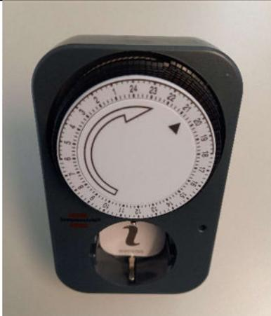
Die mechanische Zeitschaltuhr ist eine gute Möglichkeit um effizient Energie zu sparen und ermöglicht es, elektrische Geräte zu bestimmten Zeiten automatisch ein- und auszuschalten. Beispielsweise Lichterketten in der Adventszeit können so zeitlich geschaltet werden.
